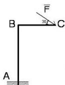
10. На Г-образную раму **ABC** с жёсткой заделкой в точке **A** действует в плоскости рамы сила **F** = 10 н, **AB** = 3 м, **BC** = 2 м. Определить величину вертикальной силы реакции заделки.
