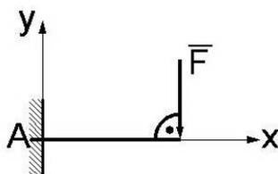
16. . Указать все ненулевые реакции невесомой консольной балки, на которую действует сила  $\vec{F}$  ( $X, Y$  - реакции вдоль осей  $x, y$  соответственно,  $M$  - момент заделки).
